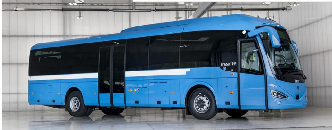
Le constructeur Irizar a présenté le 17 septembre 2021 un autocar modèle i4 classe II fonctionnant au gaz naturel liquéfié (GNL) avec une autonomie allant jusqu'à 1 000 kilomètres pour une utilisation interurbaine ou sur de courtes distances. Il intègre deux réservoirs cryogéniques cylindriques (-162°C) situés longitudinalement de part et d'autre dans le compartiment à bagages central de l'autocar, qui est complètement étanche
