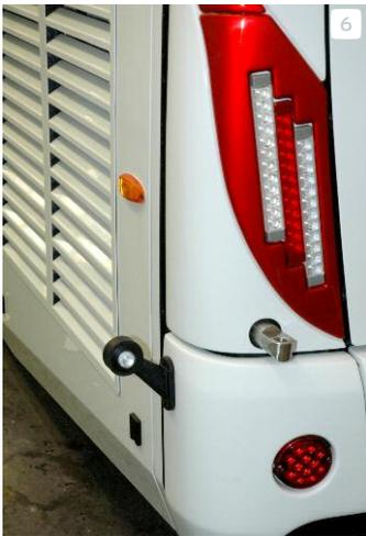
**6** Détail intéressant de l'éclairage arrière. Le support flexible des lanternes arrière assure une excellente vision de celles-ci depuis les rétroviseurs tout en préservant leur intégrité lors des manœuvres.
