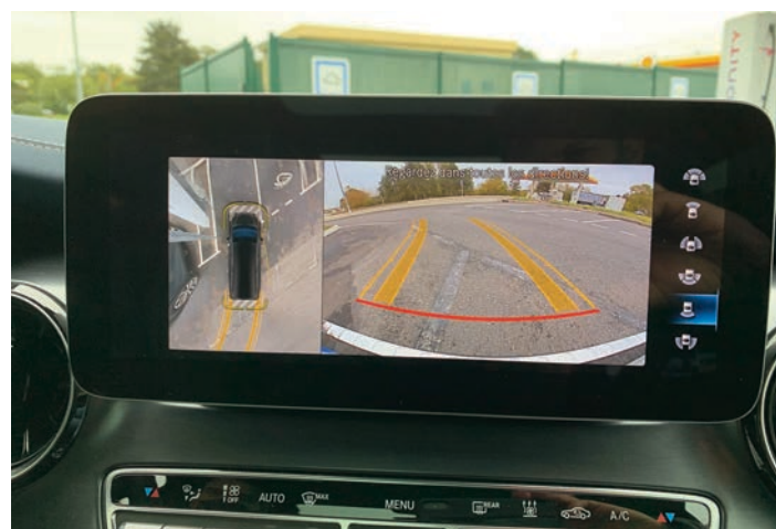
5 Le véhicule d'essai disposait de caméras 360° pour visualiser son environnement pendant les manœuvres en marche arrière.
